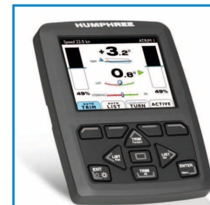
Il pannello di controllo (sopra), posizionato in plancia di comando, riporta in tempo reale tutto il lavoro che svolgono gli interceptor. A sinistra, la centralina di comando racchiude i sensori e il processore dati.
