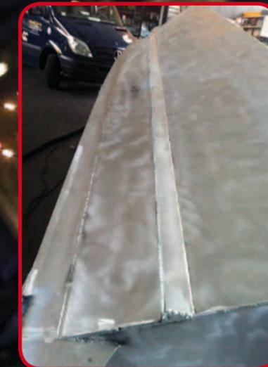
facevano certo della stabilità il loro punto forte. Inoltre, le barche di alluminio costruite con professionalità e attenzione sono compartimentate in maniera stagna con all'interno riserve di galleggiamento di poliestere tagliato a caldo e incollato che garantiscono la completa inaffondabilità della barca.
