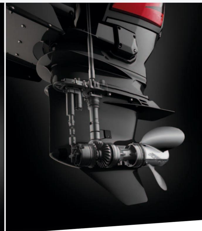
Il piede e la scatola ingranaggi SLX presentano una pompa dell'acqua ad alta capacità, il cambio elettrico integrato, l'albero elica di grande diametro e prese d'acqua più basse; molto curata la protezione anticorrosione.
