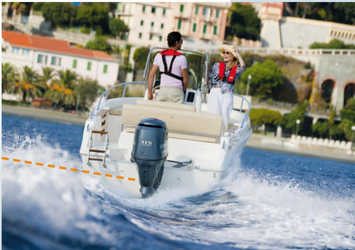
I tecnici giapponesi hanno sviluppato il nuovo F115B sulla base del motore di 1832 cc a 4 cilindri in linea e 16 valvole creando un fuoribordo incredibilmente versatile, con un peso di soli 173 kg (13 kg in meno rispetto al modello precedente) e quindi un migliore rapporto potenza/peso. La
