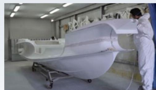
In alto, le fasi di preparazione dello stampo di un portellone prima dell'infusione sottovuoto. A sinistra, una foto della sequenza delle prove in vasca che precedono la definizione di ogni nuovo modello e si svolgono presso l'Hydrodynamic Laboratory del dipartimento di Ingegneria Industriale dell'Università di Napoli Federico
