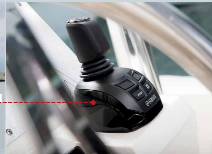
Il joystick funziona con due e tre motori
