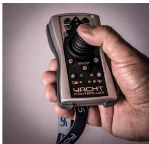
EN-JOY, grazie alla tecnologia wireless, offre in un solo strumento tutta la comodità del famoso radiocomando mobile di Yacht Controller con tutta la semplicità del joystick per ormeggiare con due dita qualsiasi barca da 9 a 50 metri. E si può installare su qualsiasi motore, anche se datato.
