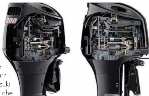
consente allo stesso propulsore di operare con rotazione destrorsa o sinistrorsa, senza dover intervenire sulla meccanica. Il DF200A sarà esposto anche in versione "Cut-Engine" dando la possibilità ai visitatori di osservarne la meccanica.
