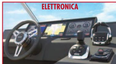
**GLASS COCKPIT SYSTEM** - Un sistema di controllo creato da Volvo Penta in collaborazione con Garmin.
