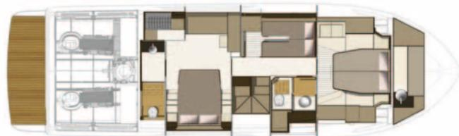
A poppavia della plancia di comando c'è la scala di discesa che porta sottocoperta dove, sul modello in prova, si è scelto di allestire due sole cabine lasciando un living di disimpegno centrale. Preferisco però la soluzione con tre cabine (la terza è prevista con cuccette sovrapposte, come è illustrato nel piano visibile qui sopra) sempre utile per lo storage se non c'è una terza coppia di amici o dei figli. Tantopiù
